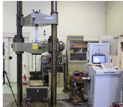
すべり試験状況
