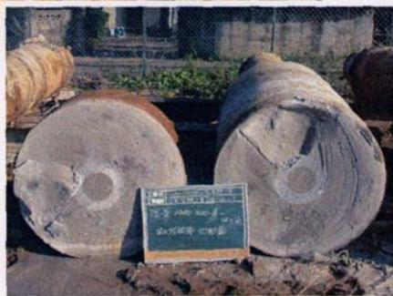
【拡大根固め球根(切断面)】
