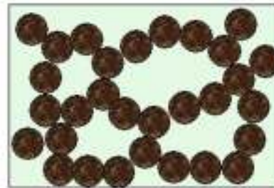
液状化前の地盤
