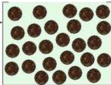
液状化した地盤
